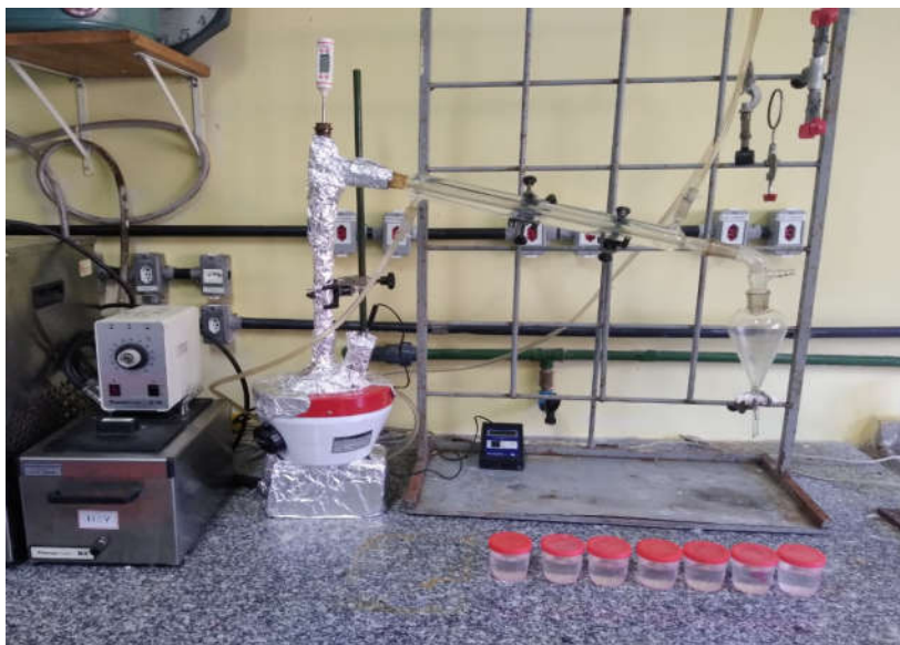
Figura 13: Experimento de bancada para avaliar a taxa de volatilização de amônia, durante a destilação de lixiviado.
