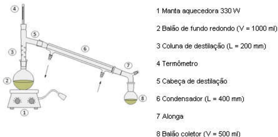
Figura 10: Layout de montagem do conjunto utilizado para a destilação de lixiviado.
