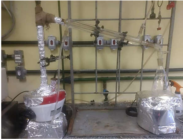
Figura 11: Instalação do conjunto de destilação de lixiviado em laboratório.
